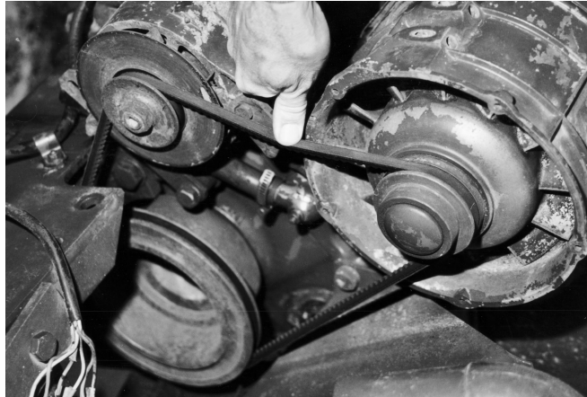
figuur 1.27 De spanning van de V-snaar controleer je op gevoel.
