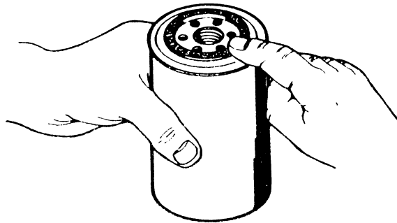
figuur 1.21 Doe eerst een beetje olie op de afdichtingsring voordat je het nieuwe filter vastdraait.
